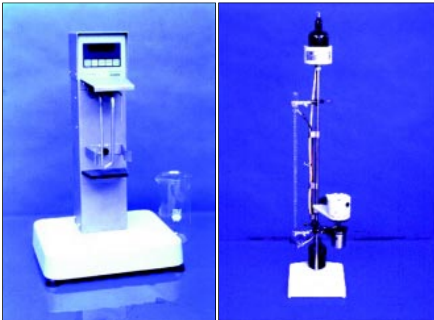
Fig. 2a-2b. Fotografía de los instrumentos para las pruebas de arcilla AFS y AM. Tanto la lavadora de arcilla de la AFS (izquierda) como el analizador de arcilla MB son importantes para el control de la arena verde.
